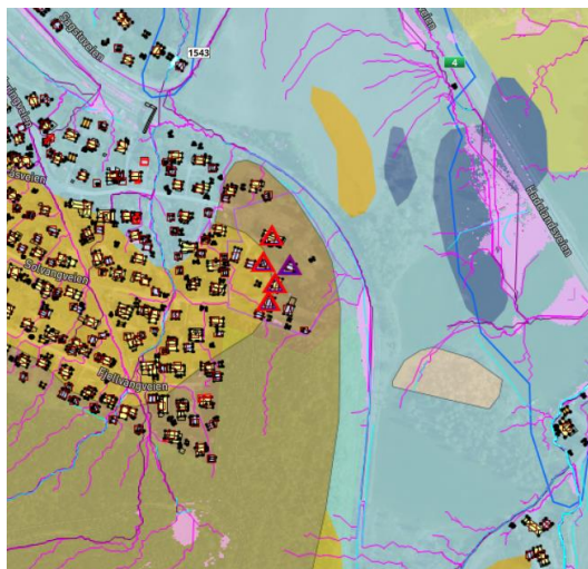
Figur: Kartutsnitt viser dreneringslinjer/ flomveier (lilla linjer) i området over området. Området består av løsmasstype tykk morene middelegnet infiltrasjonsevne med begrenset grunnvannspotensiale. Områdene rundt er det samme med 41 hav- og fjordavsetninger uegnet til infiltrasjon. Området er under marin grensen som går lenger oppe på Hakadalsfeltet.
