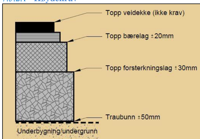
Figur 7.6: Toleransekrav i overbygningen
