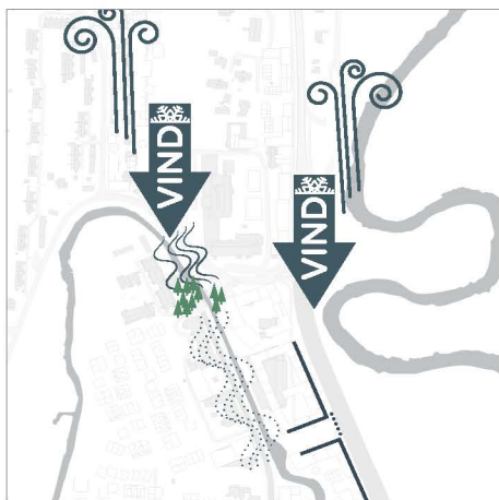
Skjerming for noravind med vegetasjon og bebyggelse
